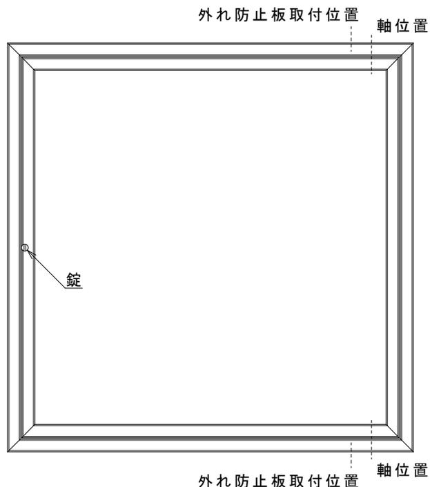
①内枠を取付け後開いた状態にて、回転軸を軸受けの端部（図の位置）まで押し込んでください。
