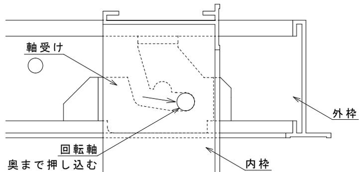
②外れ防止板を外枠軸受けの図の位置に合わせてさし込んでください。その後、図の位置に3φの下穴をあけて、タッピングビスで固定してください。下穴をあけない場合は、A型タッピングビスで固定してください。
